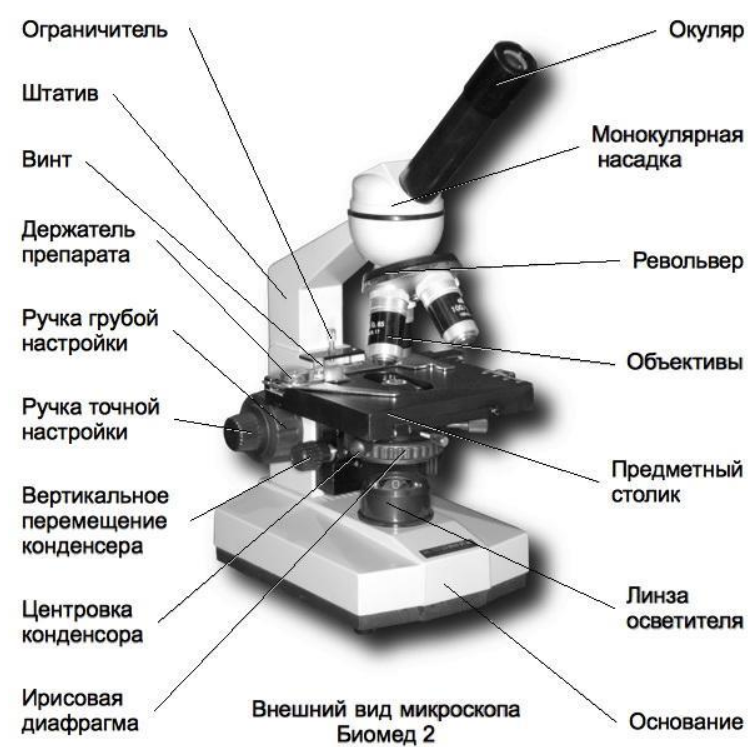
Рис. 31 Строение микроскопа
